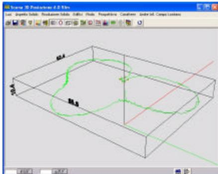
**H. Isolivello.** Il volume viene rappresentato da un'unica curva che passa per i massimi di potenza irradiata (vedi figura).
