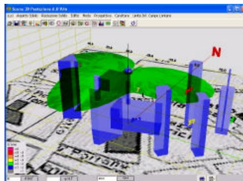
È possibile attivare la rappresentazione del limite di incertezza di calcolo, definito con una delle due opzioni della voce di menu omonima. Viene rappresentata una sfera per ogni Sistema radiante che compone la postazione. Essa rappresenta il limite entro il quale il calcolo potrebbe essere impreciso (zona di Fresnel - vedi figura). Fare attenzione: un'illuminazione non adeguata potrebbe impedire una corretta visualizzazione della griglia sferica.
