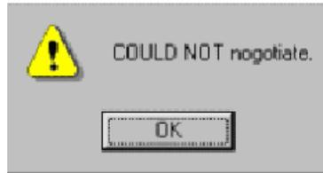
Qualora ci siano dei problemi di registrazione della connessione GSM tra i gestori, appare questo messaggio. Questo messaggio può apparire quanto c'è una congestione di traffico oppure non è possibile effettuare il roaming da parte dei gestori.
