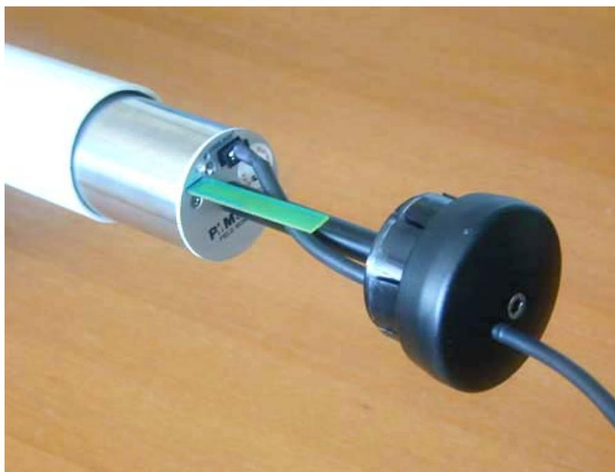
Fig. 2-5 Estrazione del misuratore dall'involucro protettivo
