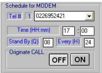
La programmazione consiste nell'impostare l'orario di accensione del Modem GSM interno, l'intervallo di ripetizione della chiamata e il periodo di funzionamento.
