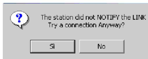
Rispondere **NO** cercando di risolvere il problema verificando il buon funzionamento del cavo e se è stato collegato sulla porta utilizzata dal software 8057-SW02.
