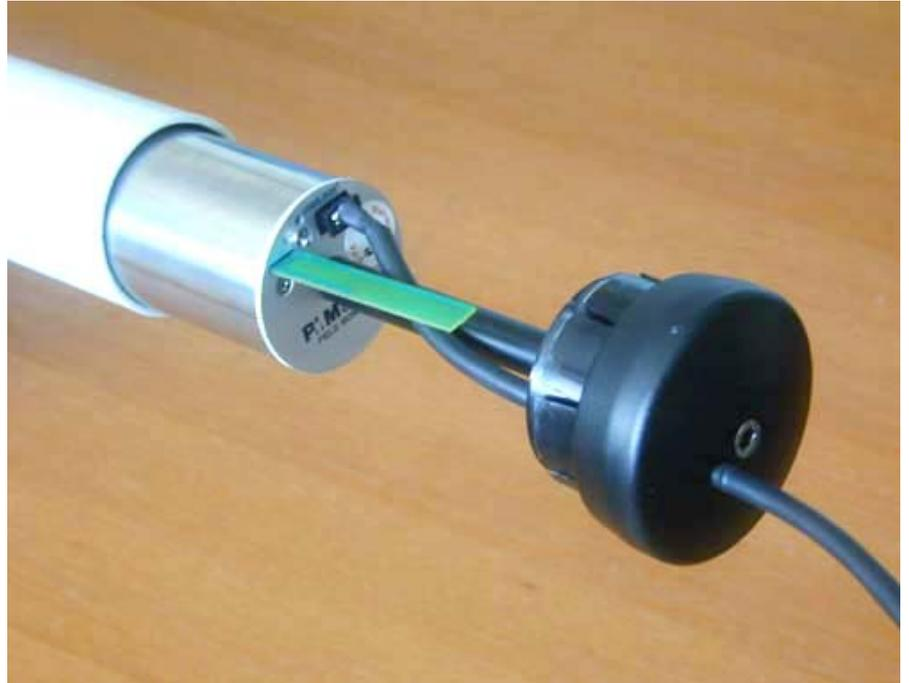
Per rimuovere il tappo inferiore del contenitore si deve prima allentare la vite a brugola e poi agire premendo sulla stessa in modo da sbloccare il meccanismo a cuneo che fa pressione sul tubo.
