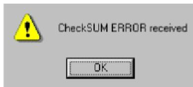
La verifica del checksum garantisce la qualità dei dati ricevuti. In presenza di questo errore alcune volte il software 8057-SW02 esce dalla propria applicazione.
