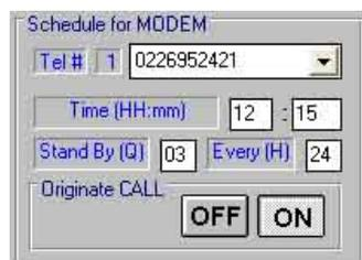
Abilitando il comando PC Answering, quando la centralina chiamerà il modem collegato al PC ad una ora prefissata scaricherà automaticamente tutti i suoi dati. Ovviamente la centralina dovrà essere stata precedentemente programmata per effettuare questa operazione. Pertanto la prima volta, occorre seguire questa procedura:
