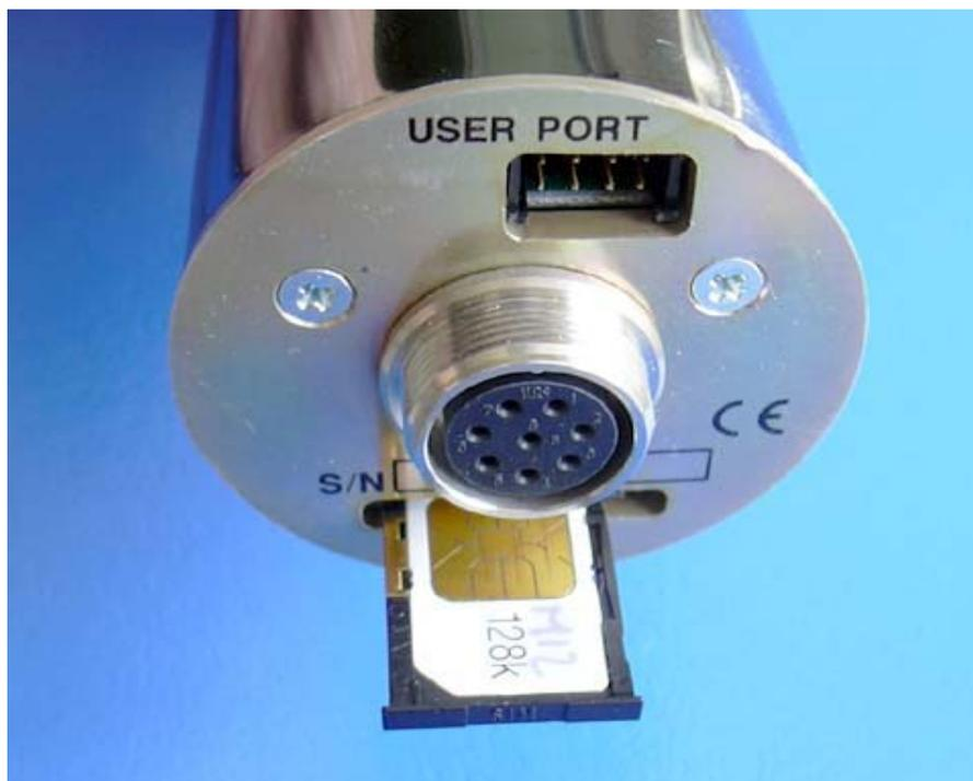
Il modem per lo scambio di dati è alloggiato all'interno dell'unità principale e la SIM Card deve essere inserita nell'apposita fessura come indicato in figura, per l'estrazione agire sul pulsante laterale.
