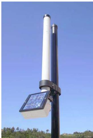
La centralina non ha comandi o connessioni accessibili sulla parte esterna del contenitore di protezione, in considerazione del fatto che il suo impiego è previsto all'esterno e che le principali operazioni sono effettuate per via remota, tramite connessione con modem cellulare GSM.
