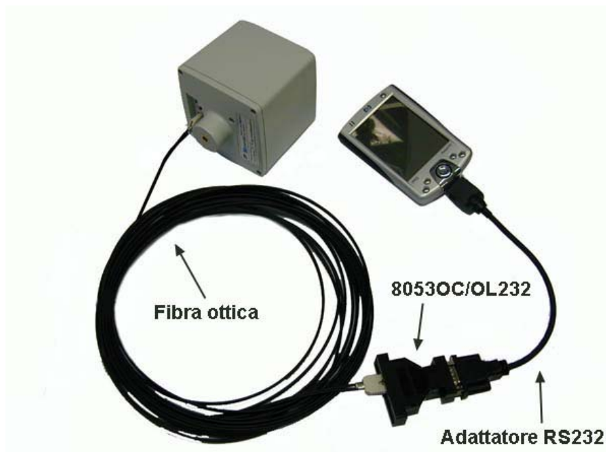
Esempio di collegamento PMM EHP-50B/C – Pocket PC
