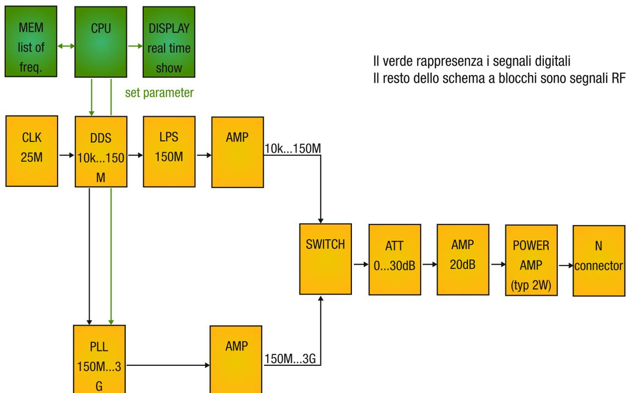
Il sistema riceve in input (tramite il suo software) una lista di frequenze che la CPU (Central Processing Unit) trasmette al DDS (Direct Digital Synthesis).
