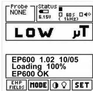
1. La pressione del tasto funzione **SET** permette di entrare in una finestra dove possono essere scelti i principali parametri e le principali impostazioni di misura.
