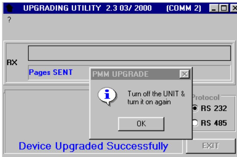
Premere **OK** e spegnere lo strumento. Accendere nuovamente lo strumento per verificare che la nuova release sia stata correttamente scaricata.
