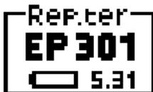
Una volta terminata correttamente la connessione nel riquadro in alto a sinistra, denominato **Rep.ter**, del PMM 8053B sarà indicato il corretto funzionamento del ripetitore ottico, lo stato di carica della sua batteria interna, verrà inoltre indicato il tipo di sonda collegata al ripetitore.
