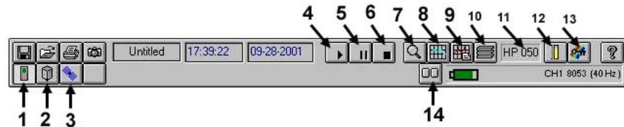
Selezionando l'**icona del Device 1 (1)**, all'interno della quale appare l'icona del PMM 8053, verrà attivato l'8053 e il suo probe utilizzato per la misura (**HP050 (11)**); verranno attivati lo **Start Measure (4)**, il **Rcl Records (10)**, il **Field Meter (12)** e il **Device Setup (14)**.
