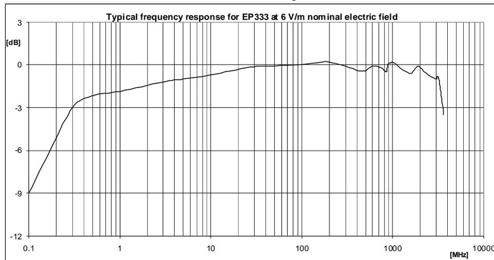
La sonda EP-333 è stata sviluppata appositamente per la misura RMS di segnali digitali con elevati fattori di cresta che con tradizionali sensori a diodo vengono normalmente sovrastimati.
