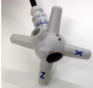
Questa sezione illustra l'installazione e l'uso del sensore di Campi Elettrici PMM EP600/EP601.
