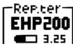
Una volta terminata correttamente la connessione nel riquadro in alto a sinistra, denominato **Rep.ter** sarà indicato il corretto funzionamento dell'analizzatore, con la scritta **EHP 200**, e lo stato di carica della sua batteria interna.
