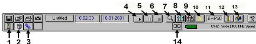
Selezionando l'**icona del Device 2 (2)**, all'interno della quale appare l'icona dell'EHP-50C, verrà attivata l'EHP-50C e visualizzato il suo probe utilizzato per la misura (**EHP-50C stessa (11)**), verrà attivato lo **Start Measure (4)**, lo **Spectrum Mode (10)**, il **Field Meter (12)** e il **Device Setup (14)**.
