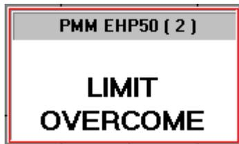
La finestra grigia mostra il sensore utilizzato il cui allarme è stato superato, ed a quale canale la sonda o il ripetitore ottico è stato collegato al commutatore SB-04.
