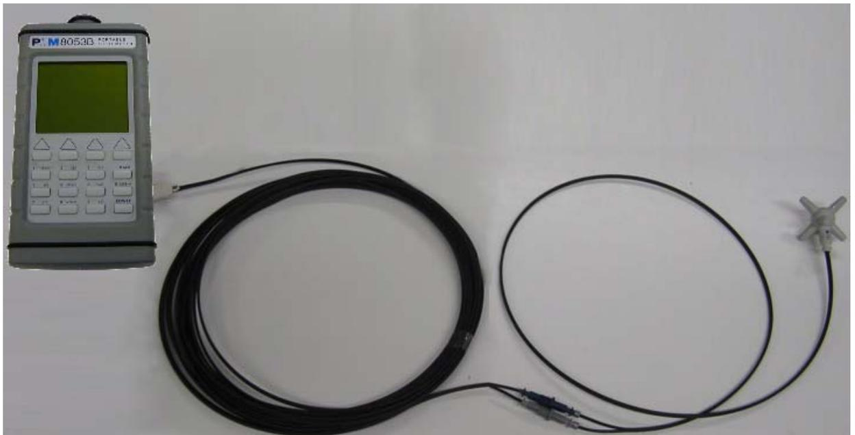
Questa impostazione permette al PMM 8053B di collegarsi e di riconoscere automaticamente il sensore EP600/EP601 attraverso la connessione a fibra ottica. Con questa impostazione la connessione seriale via cavo (Wired) è disabilitata.
