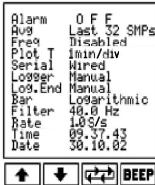
Indipendentemente dalla modalità d'uso scelta, prima di iniziare la misura occorre impostare i principali parametri e le principali impostazioni di misura all'interno della funzione **SET**:
