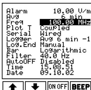
Inserendo il valore di una frequenza da misurare conosciuta, il PMM 8053B correggerà la misura effettuata usando un fattore di correzione inserito in una tabella interna alla sonda. Ciò permetterà di ottenere una misura molto precisa del valore di campo sulla frequenza scelta.
