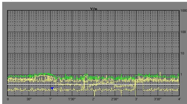
che consiste nel posizionare (sull'asse precedentemente scelta), con il mouse, il triangolo blu del **Marker** sul punto di inizio e, mantenendo premuto il tasto sinistro del mouse, trascinare il **Marker**, per un periodo non inferiore ai 2 minuti, in modo tale da visualizzare due barre verticali che aiutano la selezione sul punto di fine del tratto che si desidera espandere.
