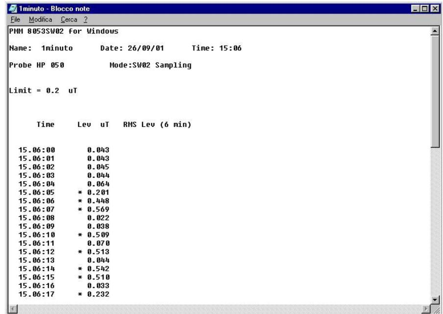
Se il Limite viene attivato ed il campo eccede tale valore, il software mostra un messaggio sullo schermo del PC di superamento del limite stesso.
