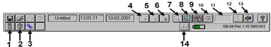
Selezionando l'**icona del Device 3 (3)**, all'interno della quale appare l'icona del Satellite, verrà attivato l'8053-GPS e nell'**Active probe (11)** verrà visualizzata la scritta **Unlock** se il GPS sta cercando la posizione esatta. Saranno disabilitati i pulsanti **Start Measure (4)**, **Pause (5)**, **Stop (6)**, **Zoom Mode (7)**, **Fields Meter (12)** e **Device Setup (14)** mentre verrà abilitato il pulsante **Satellites (10)**.
