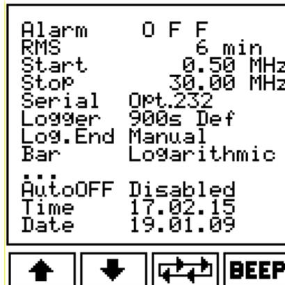
Con i parametri **Start** e **Stop** è possibile impostare la gamma di frequenza di lavoro dell'EHP-200.
