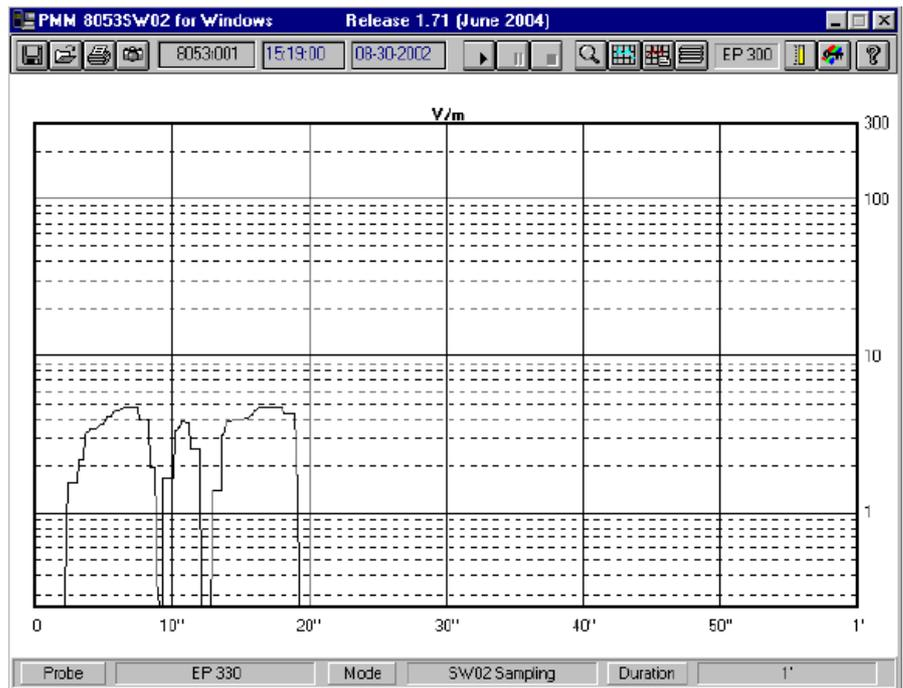
Con il misuratore 8053B collegato al PC, via cavo o fibra ottica, è possibile iniziare una nuova acquisizione premendo il **pulsante Play** che darà la possibilità di veder l'andamento dei valori acquisiti dalla sonda in un determinato tempo; dopodiché si potrà procedere alle operazioni descritte nei capitoli precedenti.
