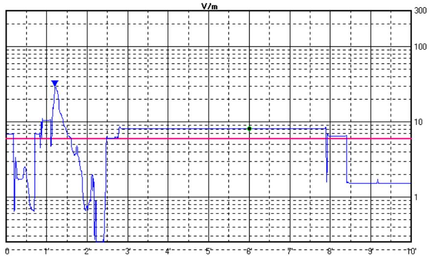
E' possibile selezionare la scala fra logaritmica o lineare tramite le impostazioni di **Setup**. È inoltre possibile visualizzare la traccia del valore di campo isotropico e le tre componenti assiali X-Y-Z selezionando **Show** e **Log** tramite le impostazioni di **Setup**.
