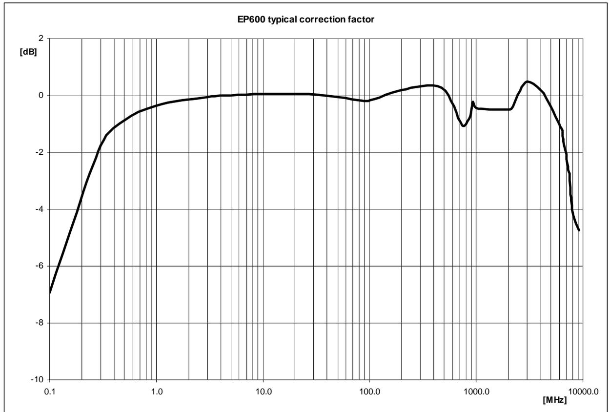
**Fig. 10-2** Fattore di correzione EP600
