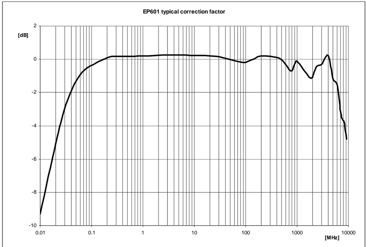
**Fig. 10-3** Fattore di correzione EP601
