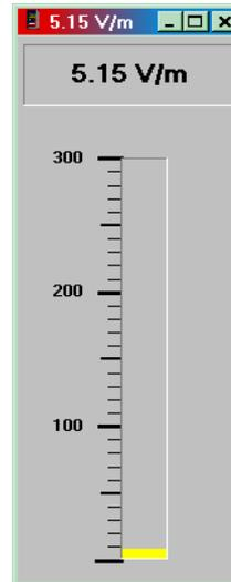
Se **X-Y-Z Axis** nella finestra di **Setup** è selezionato verranno visualizzate, oltre al valore del totale isotropico, anche le barre ed i valori relativi alle singole componenti X-Y-Z.
