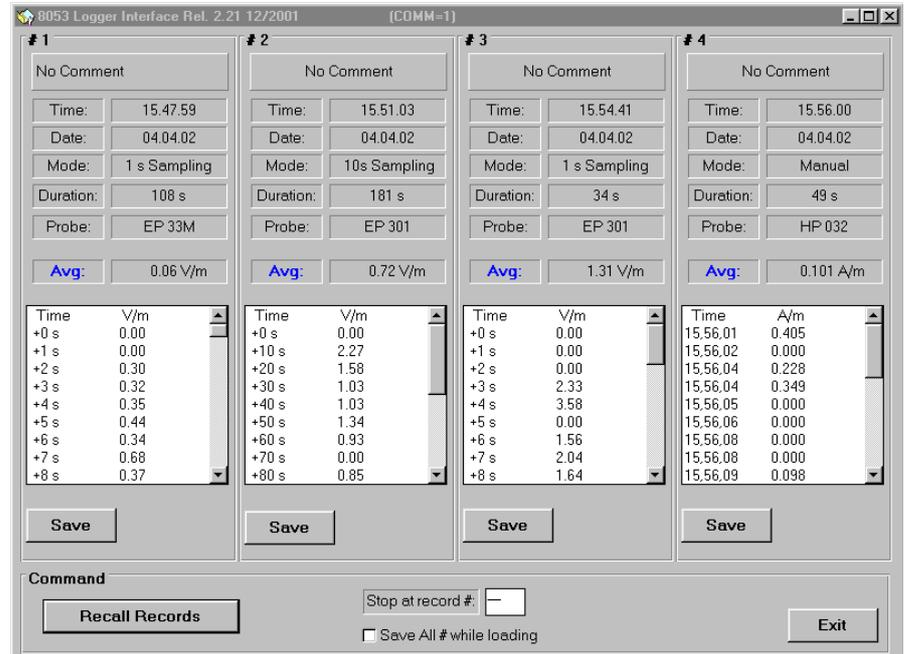
Il PMM 8053B trasferirà sempre gli ultimi quattro record memorizzati. Per esempio se sono stati salvati 5 record nel PMM 8053B il programma trasferirà gli ultimi quattro (2, 3, 4 e 5).
