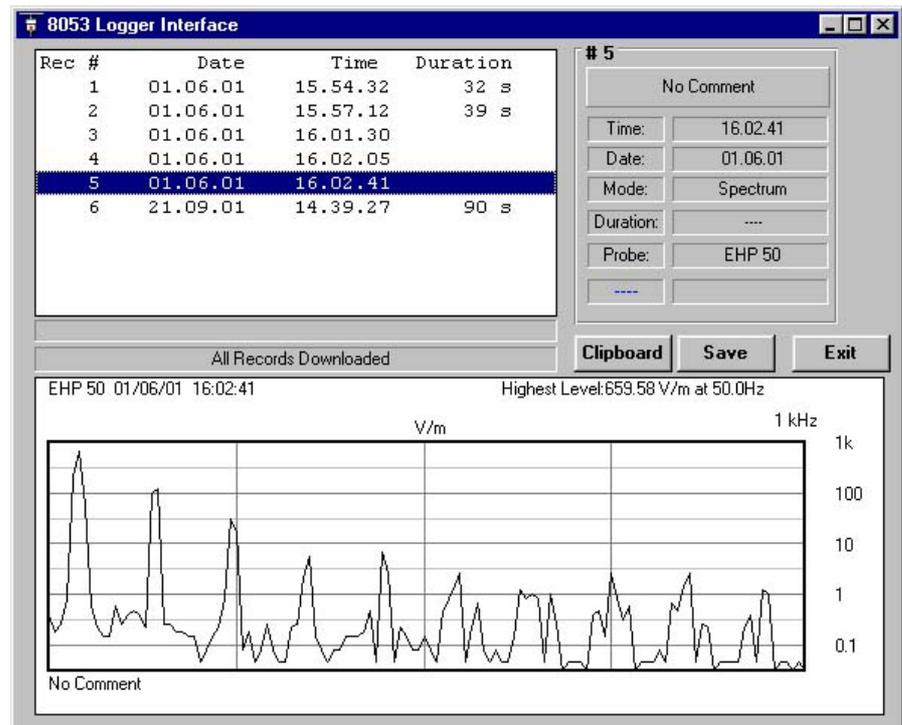
La parte sinistra della finestra evidenzia i record scaricati dal PMM 8053B. La parte destra evidenzia i parametri del record selezionato.
