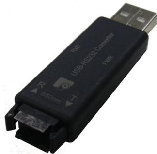
L'USB-OC è un accessorio del sistema PMM 8053B di misura di campi elettromagnetici.
