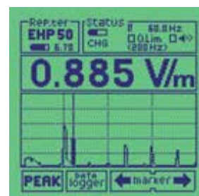
Valore di campo Elettrico alla frequenza del marker nella visualizzazione dello spettro
