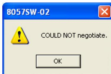
Qualora, in modalità CSD, ci siano dei problemi di registrazione della connessione GSM tra i gestori, appare questo messaggio. Questo messaggio può apparire quanto c'è una congestione di traffico oppure non è possibile effettuare il roaming da parte dei gestori.
