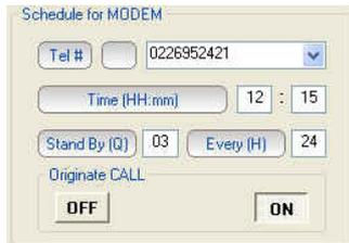
Abilitando il comando PC Answering, quando la centralina, provvista di modem GSM e abilitata alla comunicazione CSD, chiamerà il modem collegato al PC ad una ora prefissata scaricherà automaticamente tutti i suoi dati. Ovviamente la centralina dovrà essere stata precedentemente programmata per effettuare questa operazione.
