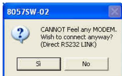
Attivare **SI** per entrare nel menu della centralina per scaricare i dati o cambiarne la configurazione.
