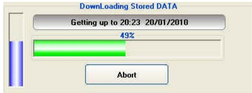
La barra verticale indica la percentuale di scaricamento sul totale dei dati mentre la barra orizzontale mostra lo scaricamento ad ogni intervallo di sei ore.
