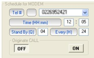
Il modem interno della centralina (AMB-8057/02 o /03) resterà acceso, in stand-by ed indipendentemente dalla programmazione dell'utilizzatore, per 60 minuti a partire dall'accensione della centralina stessa.
