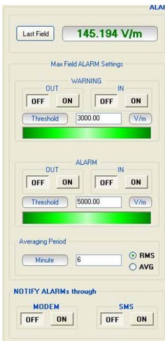
**Fig. 6-6** Last Field e Impostazioni soglia di Allarme e Attenzione nel pannello delle impostazione. Riferito alla sonda secondaria.
