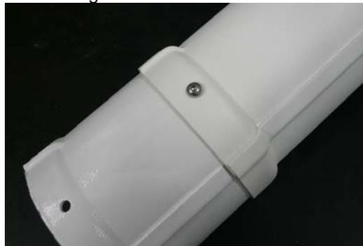
Inserire l'involucro lungo l'asse della centralina e fissarlo al fondello con le tre viti precedentemente rimosse. A questo punto, la centralina può essere installata sul sito di prova seguendo le istruzioni fornite nel capitolo 1 e 2.
