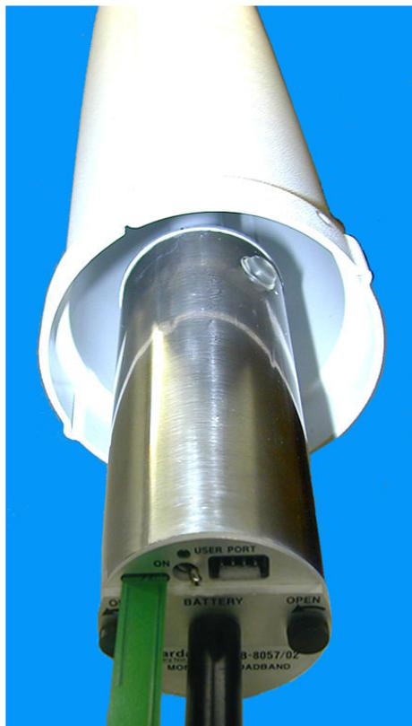
**Fig. 2-4** Rimozione dell'involucro dall'AMB-8057/02
