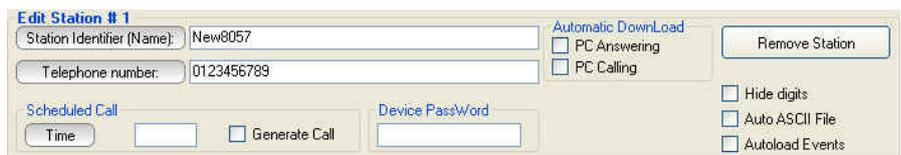
A questo punto è possibile editare i dati che è necessario cambiare, attivare o disattivare le funzioni di scaricamento automatico, di chiamata automatica, di generazione automatica dei file TXT o modificare lo stato della funzione relativa alla visualizzazione dei dati (nome e numero telefonico). Per ognuna delle operazioni suddette il programma richiede l'inserimento della *terminal password* di sicurezza.
