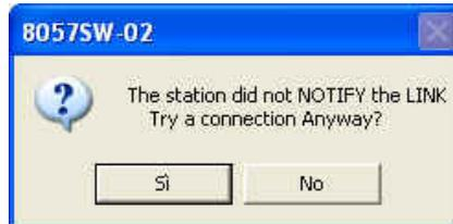
Rispondere **NO** cercando di risolvere il problema verificando il buon funzionamento del cavo e se è stato collegato sulla porta utilizzata dal software 8057-SW02.
