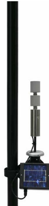
**Fig. 6-3** Configurazione Doppia-sonda (vista interna): EP-1B-04 montata come sonda secondaria
