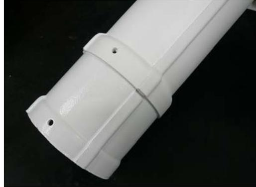
Fissare la prolunga 8057-extension attraverso le viti fornite tenendo i dadi all'interno dell'involucro e le rondelle in plastica all'esterno. Avvitare le viti utilizzando la chiave a brugola da 2.5mm.
