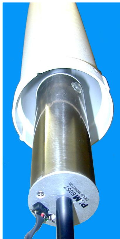
**Fig. 2-5** Rimozione dell'involucro dall'AMB-8057/03
