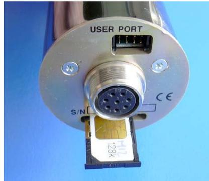
Fig.4-3 Installazione SIM card
