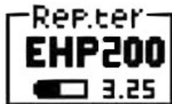
Una volta terminata correttamente la connessione nel riquadro in alto a sinistra, denominato **Rep.ter** sarà indicato il corretto funzionamento dell'analizzatore, con la scritta **EHP 200A**, e lo stato di carica della sua batteria interna.
