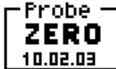
Nella finestra in alto a sinistra sul display del PMM 8053B apparirà la scritta ZERO che indica che il PMM 8053-ZERO è stato correttamente riconosciuto dallo strumento.
