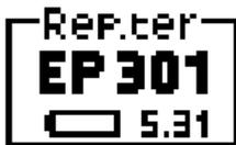
Una volta terminata correttamente la connessione nel riquadro in alto a sinistra, denominato **Ref.ter**, del PMM 8053B sarà indicato il corretto funzionamento del ripetitore ottico, lo stato di carica della sua batteria interna, verrà inoltre indicato il tipo di sonda collegata al ripetitore.
