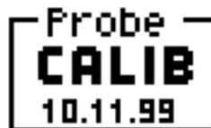
Nella finestra in alto a sinistra sul display del PMM 8053B apparirà la scritta CALIB che indica che il PMM 8053-Cal è stato correttamente riconosciuto dallo strumento.
