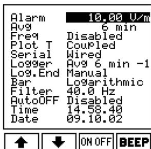
Questa funzione può essere usata per definire il livello di allarme per abilitare il beep oppure utilizzata con la funzione del Data logger: Over Limit.
