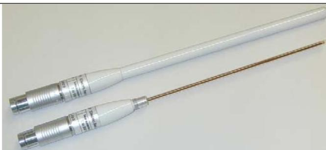
A differenza di tutte le sonde passive che vengono riconosciute dall'8053B e dall'OR03 indifferentemente prima o dopo l'accensione dell'unità in questione, le sonde attive (con conversione a bordo) EP333 ed EP201 vengono riconosciute solo all'accensione del dispositivo.
