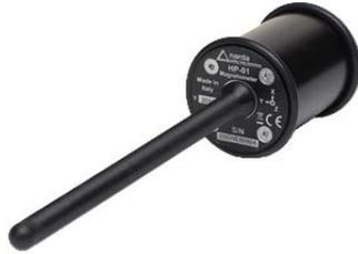
Il modello HP-01 è una sonda isotropica di campo magnetico in grado di misurare da quello statico (DC) fino alle basse frequenze (1 kHz). Lo strumento offre un'ampia gamma dinamica e consente la rilevazione contemporanea sui tre assi X, Y, Z.
