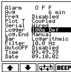
Per sostituire l'intervallo di tempo già presente nello strumento, digitare con la tastiera il nuovo numero e premere il tasto
