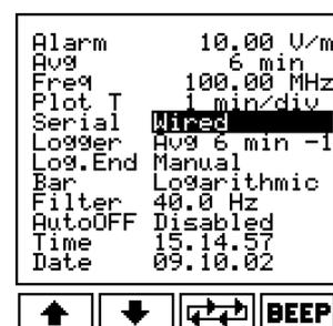
Questa funzione viene usata per trasferire dati ad un PC o per acquisire dati da un ripetitore ottico o da sonde con il ripetitore ottico interno o dal modulo GPS. In alternativa è possibile indirizzare lo stato relativo alla funzione **Alarm** sui connettori Wired o Optical.
