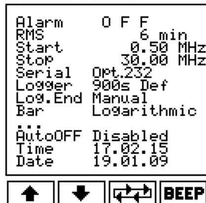
Con i parametri **Start** e **Stop** è possibile impostare la gamma di frequenza di lavoro dell'EHP-200A/AC.
