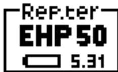
Una volta terminata correttamente la connessione nel riquadro in alto a sinistra, denominato **Rep.ter** sarà indicato il corretto funzionamento dell'analizzatore, con la scritta **EHP 50**, e lo stato di carica della sua batteria interna.
