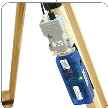
Il dispositivo non compromette la misura, poiché la sua frequenza di funzionamento (2,4GHz) è ben lontana dal range di frequenza delle sonde.
