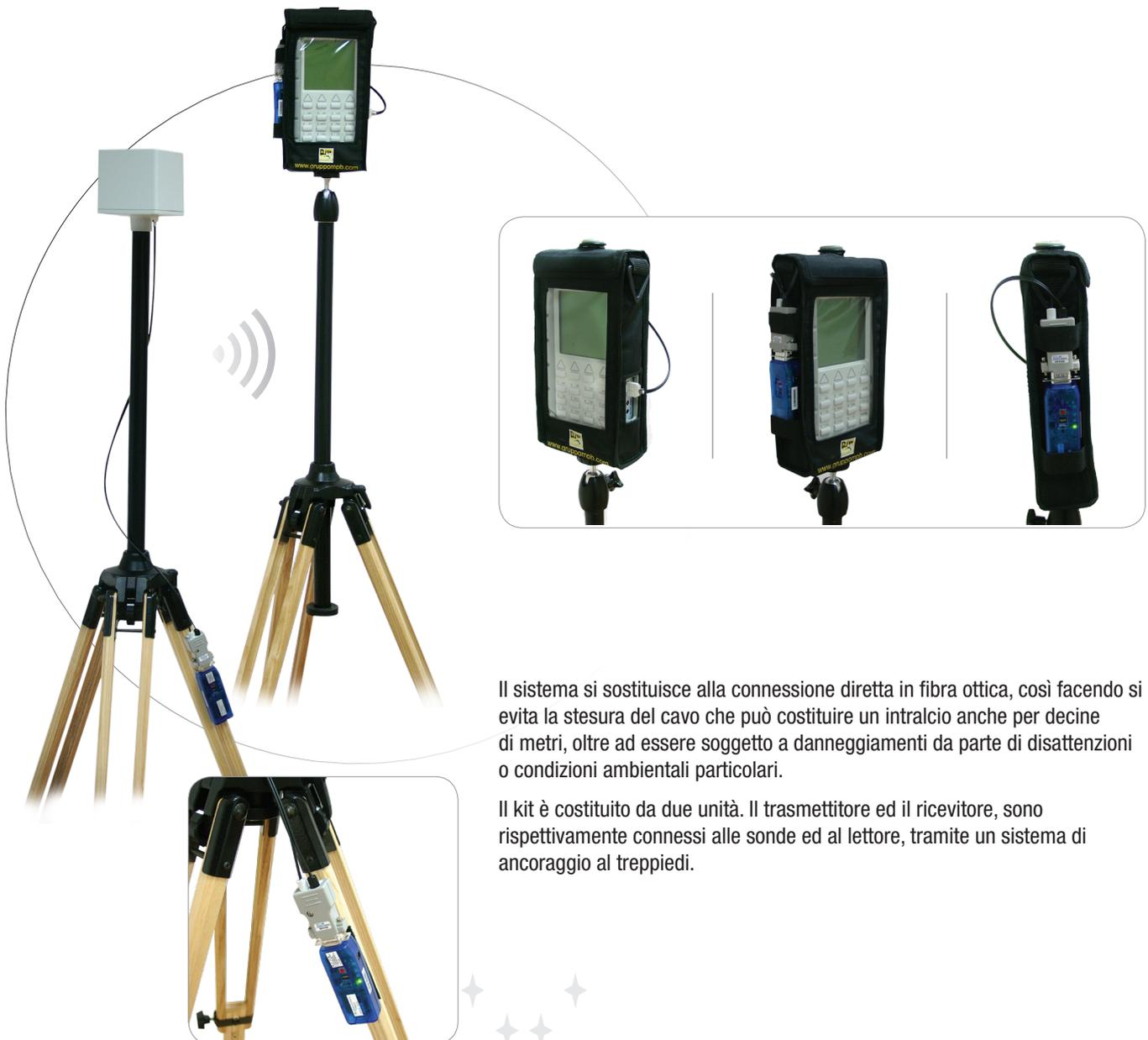
Il sistema si sostituisce alla connessione diretta in fibra ottica, così facendo si evita la stesura del cavo che può costituire un intralcio anche per decine di metri, oltre ad essere soggetto a danneggiamenti da parte di disattenzioni o condizioni ambientali particolari.
